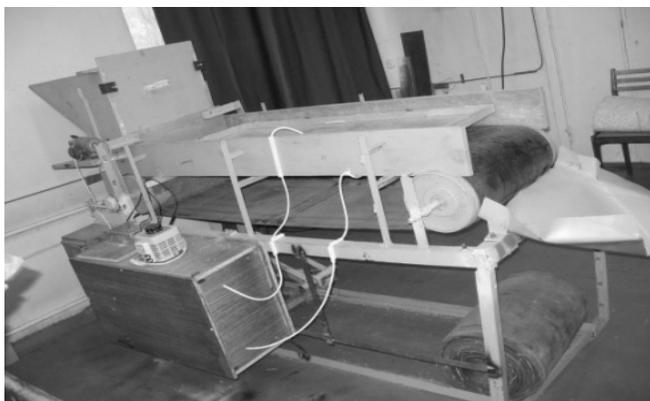
Рисунок 1 – Ленточный электрический многослойный стимулятор семян ЛЭМС
