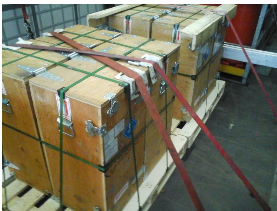
Рисунок 5 – Груз, закрепленный самозатягивающимися ремнями
