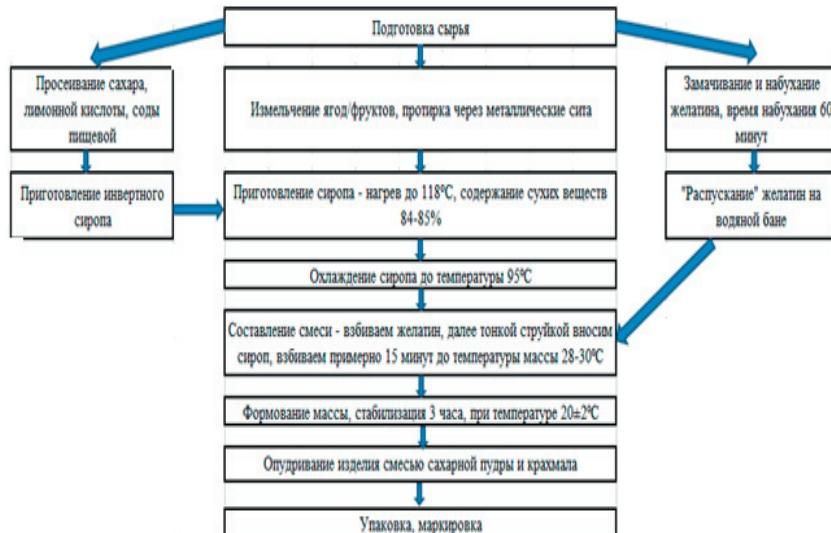
Рисунок 1 – Технологическая схема производства маршмеллоу на основе пюре из ягод и фруктов
