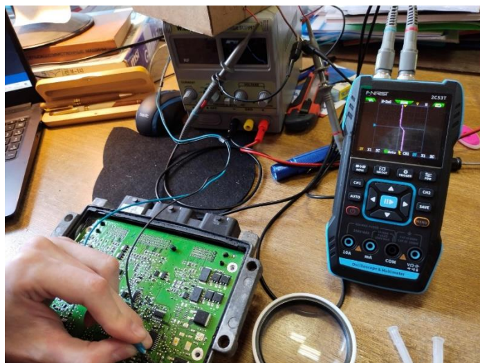
Рисунок 4 – Проверка радиодеталей на ЭБУ автомобиля Форд Фокус2
