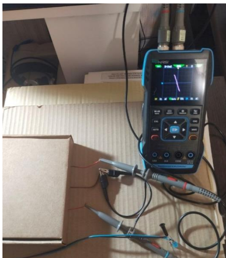
Рисунок 3 – Приставка в работе с осциллографом
