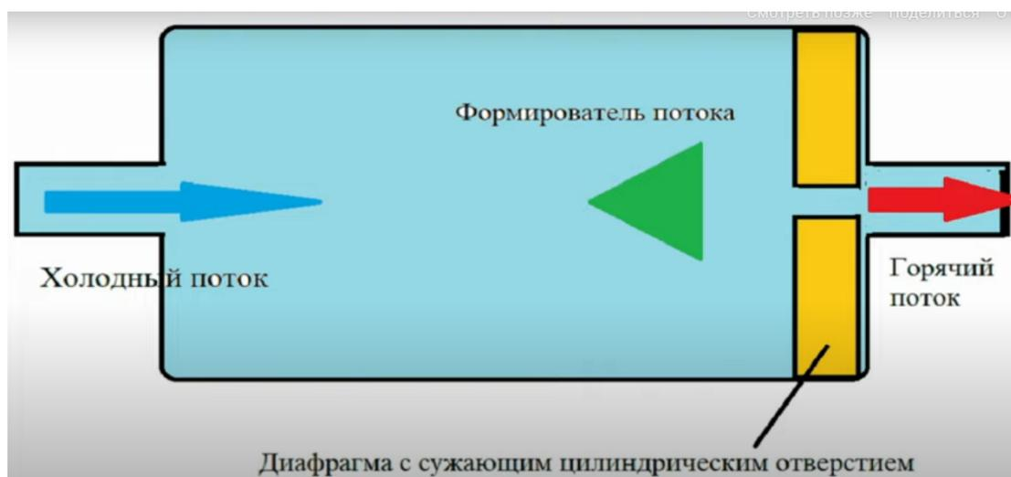
Рисунок 3 – Пассивный аксиальный теплогенератор
