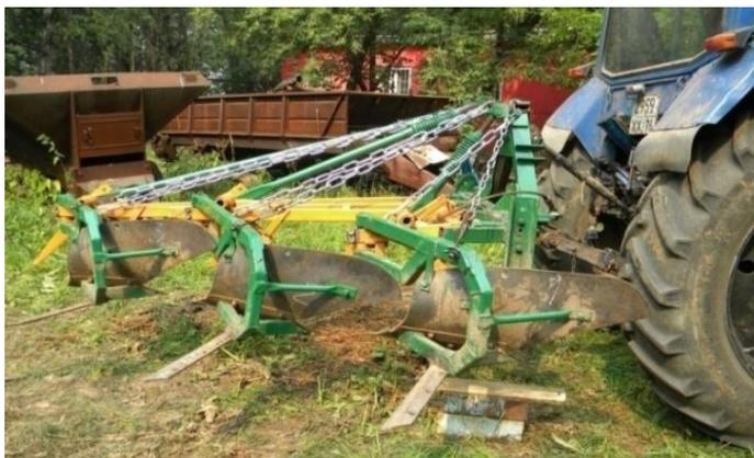
Рисунок 1 – Плуг с уравновешенными корпусами
