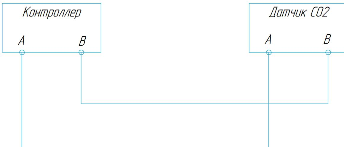
Рисунок 11 – Схема подключения датчика растворенного углекислого газа по rs-485
