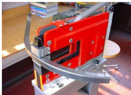
Рисунок 5 – Примеры оборудования Шринкер и Стретчер и его возможности, для исключения простоя техники в ремонте на примере ООО ЦКР Логистик+
