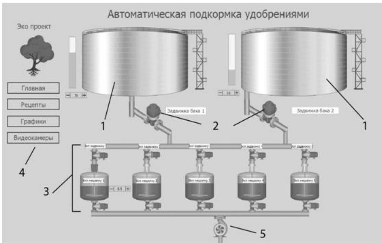
1 – баки удобрений; 2 – задвижки бака; 3 – смесительные баки; 4 – блок управления; 5 – электронасос.
