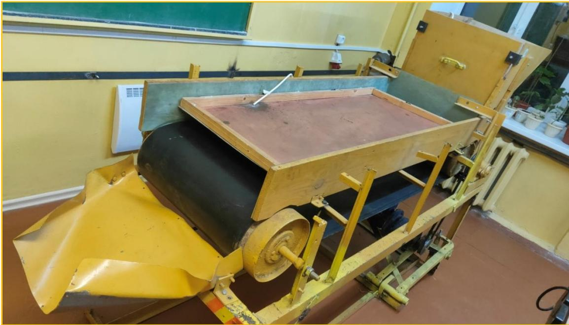
Рисунок 1 – Многослойный ленточный электрический стимулятор семян
