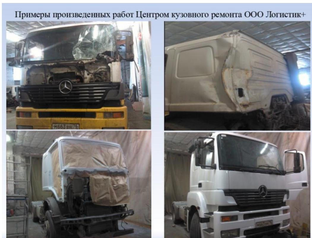
Рисунок 2 – Примеры объёма ремонтных, жестяно-сварочных и окрасочных работ, проводимых в ООО ЦКР Логистик+
