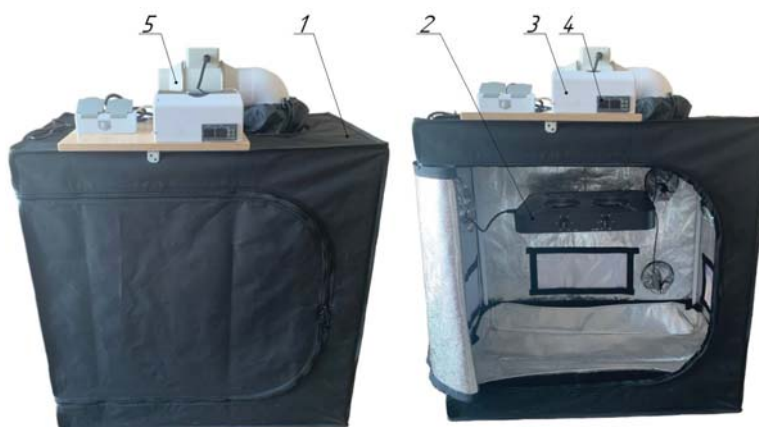
1 – корпус гроутента; 2 – фитосветильник BOSYTRO; 3 – блок управления; 4 – реле температуры и влажности; 5 – центробежный вентилятор.
