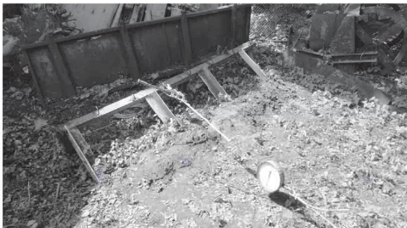
Рисунок 2 – Опытный участок, оборудованный анкерами
