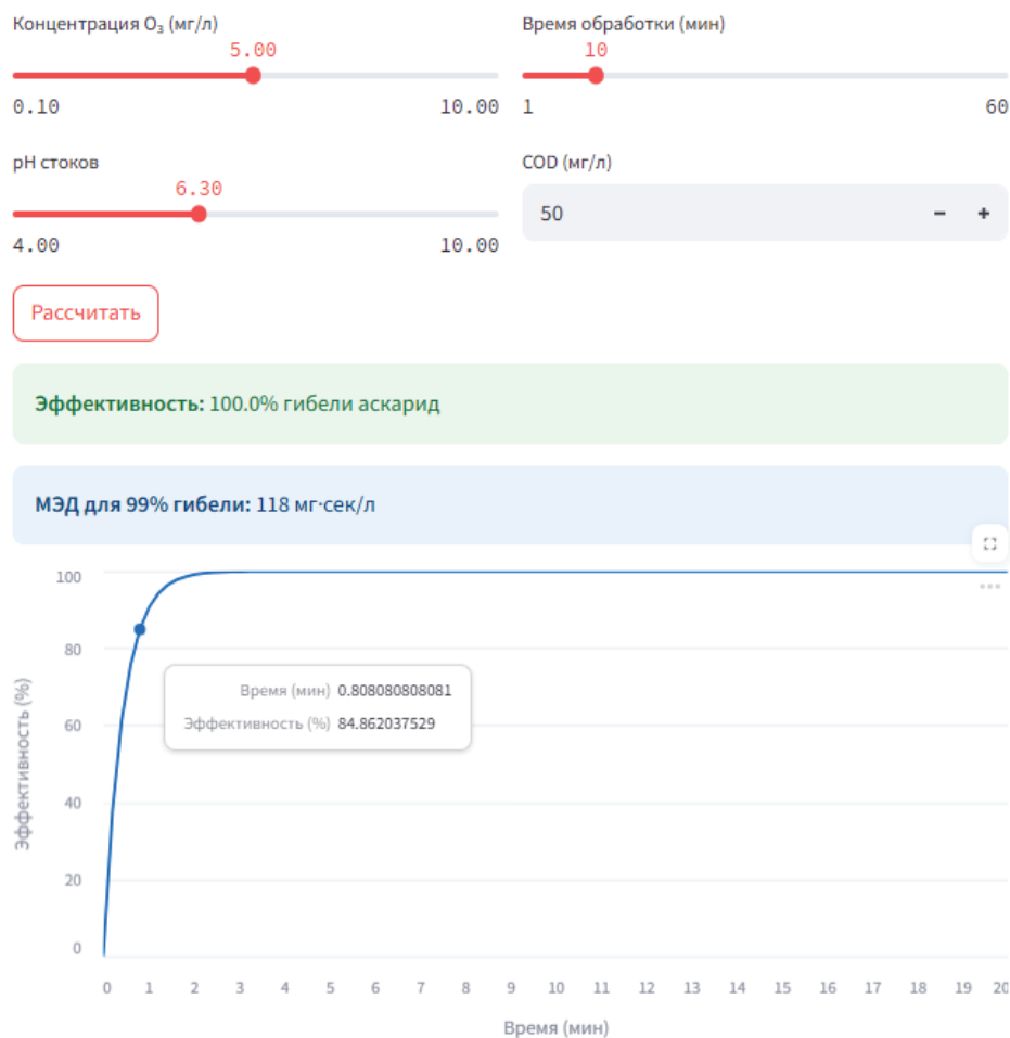
Рисунок 6 – Интерфейс цифрового симулятора для исследования процесса дегельминтизации водной суспензии
