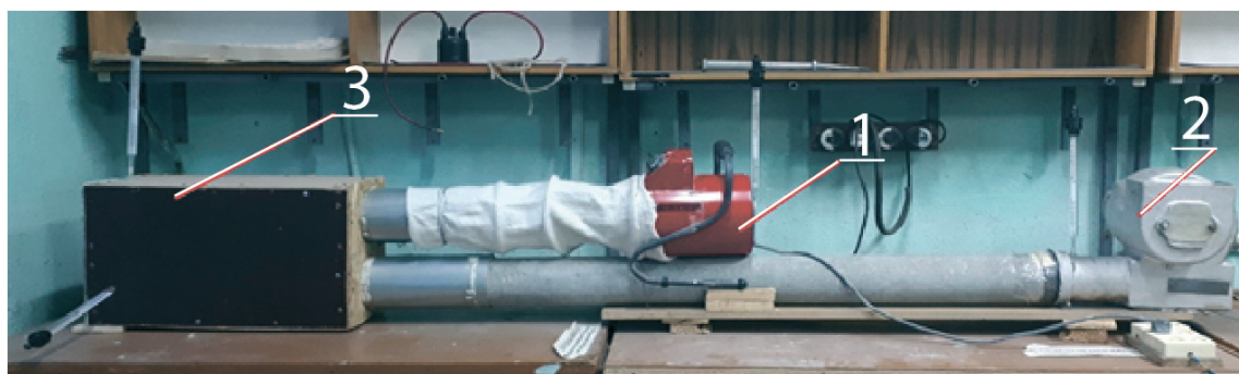
1 – тепловая пушка, 3 кВт; 2 – вентилятор холодного воздуха; 3 – теплоутилизатор.
