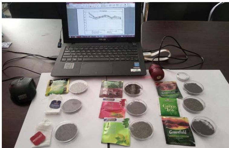
Рисунок 2 – Образцы для исследования и светодиодный ИК миниспектрометр. Справа от миниспектрометра – спектралон для калибровки
