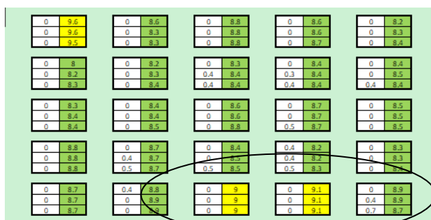
Рисунок 3 – Распределение температур воздуха в помещении первой очереди при северо-западном направлении ветра (16.03.2021, 19.03.2021 соответственно)
