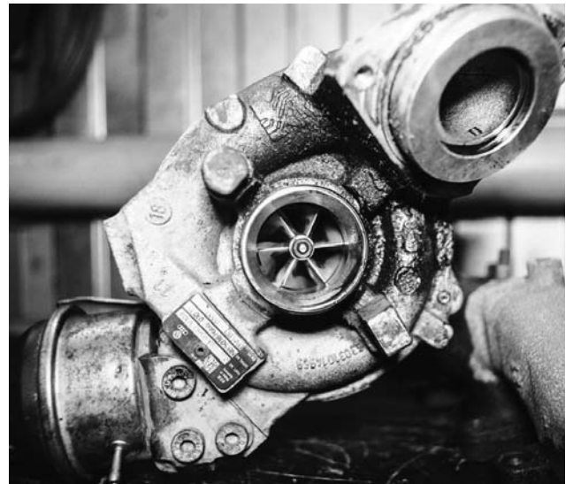
Рисунок 4 – Подтёк масла на стыке ТРК
