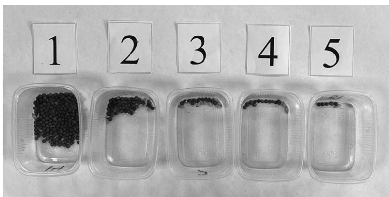
Рисунок 3 – Распределение выделенных масс семян вики ( m_v ) из ячменя в первых пяти интервалах времени ( t_v = 5 с) при n = 55 об/мин и \gamma_n = 35^\circ ( Z_n = 2\% , m_n = 1000 г)
