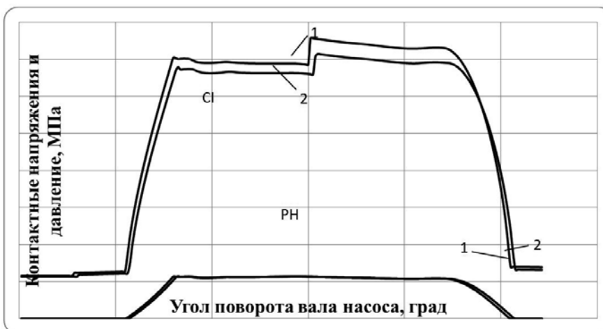
Рисунок 3 – Давление на плунжер РН при давлении в аккумуляторе 220 МПа и предельно допустимом давлении PPR при \sigma_k = 1500 МПа
