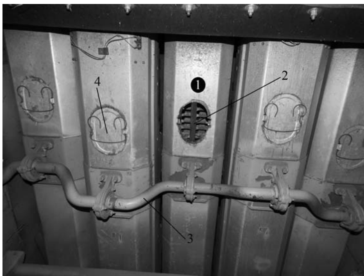
1 – клавиша соломотряса; 2 – подбивальщик; 3 – коленчатый вал; 4 – люк.
