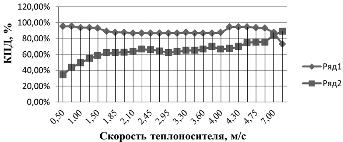
Рисунок 3 – Зависимость КПД теплогенератора от типа холодного теплоносителя
