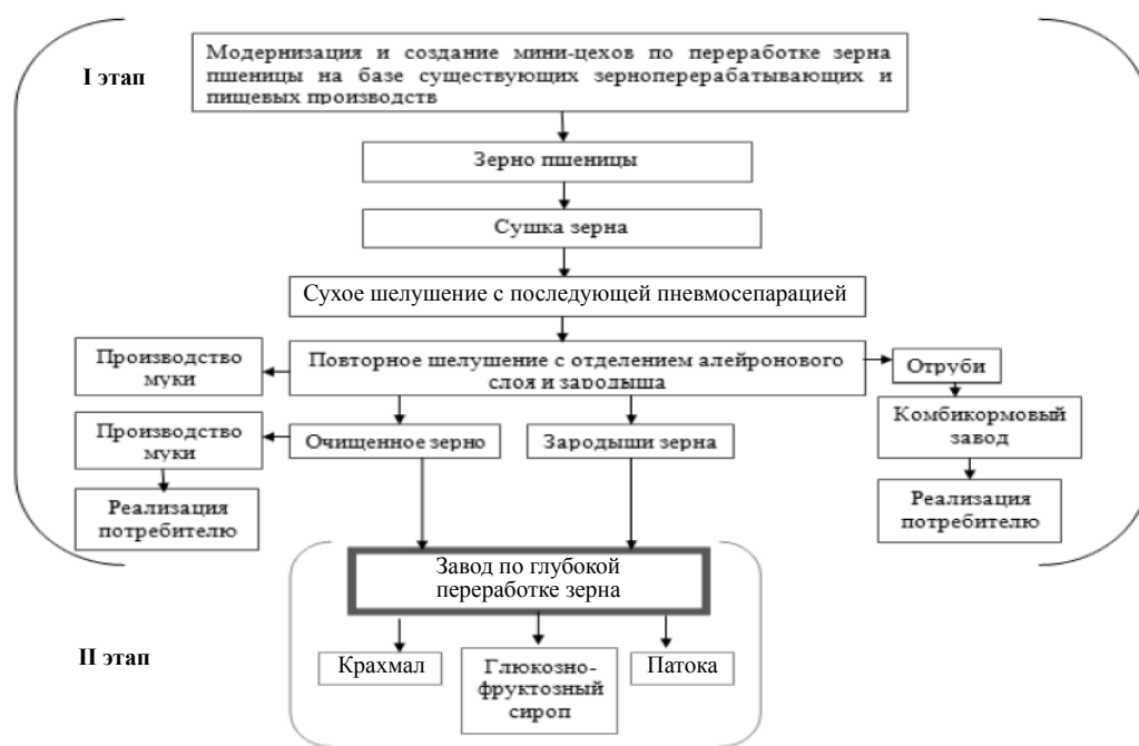
Рисунок 1 – Многоэтапная схема глубокой переработки зерна
