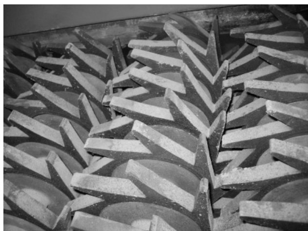
Рисунок 2 – Сепаратор почвы с резиновыми пальчатыми роторами
