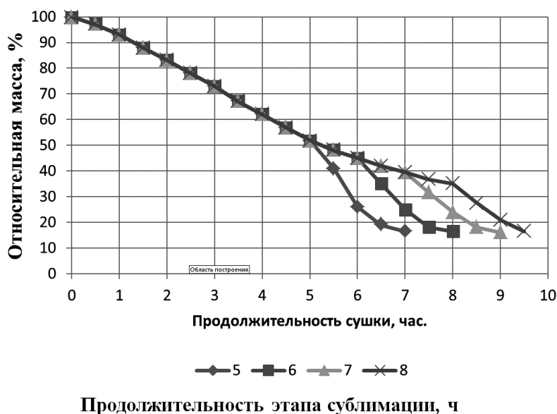
Рисунок 2 – Графики изменения относительной массы малины в процессе лиофилизации при различной продолжительности этапа сублимации
