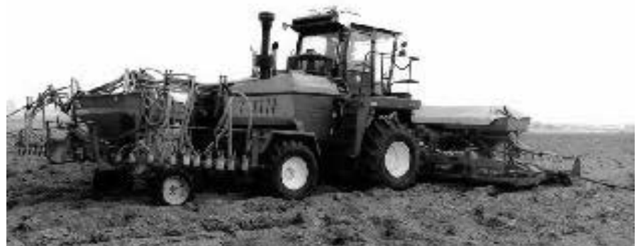
Рисунок 1 – Универсальный комбинированный агрегат УКА-6 в составе: энергосредства УЭС-2-250А, сеялки СУ-12 для внесения минеральных удобрений, бороны ротационной БНР-6, сеялки точного высева СТВ-12
